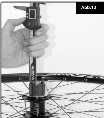
Das optimale axiale Spiel beträgt 0,15 - 0,20 mm. Mittels Passscheiben muss die Differenz zwischen dem **gemessenen Achsüberstand** (z.B.: 9,8 mm) und der immer gleichen **Einstecktiefe der Endkappe** (z.B. 9,2 mm) auf 0,15-0,20mm eingestellt werden (Abb.14). Wenn sich der **Überstand der Achse mit Passscheiben** im angegebenen Bereich befindet, dann ist das axiale Lagerspiel perfekt eingestellt.
