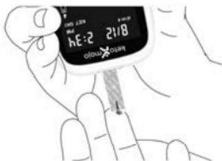
Lo strumento esegue il conto alla rovescia di 10 secondi e il risultato appare sul display dopo un segnale acustico. Il risultato del test verrà visualizzato per 3 secondi e automaticamente memorizzato nella memoria del misuratore. Il misuratore passerà al test GKI.
