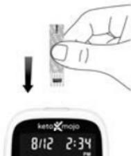
3. Lo strumento si accende dopo un segnale acustico. Apparirà l'immagine di una striscia reattiva con una goccia di sangue lampeggiante che indica che lo strumento è pronto per il test.
