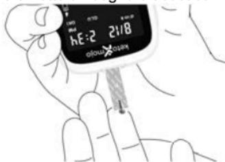
Il misuratore esegue il conto alla rovescia di 5 secondi e il risultato della glicemia appare sul display dopo un segnale acustico. Il risultato del test verrà visualizzato per 1 secondo e verrà automaticamente memorizzato nella memoria del misuratore. Il misuratore passerà al test dei chetoni.
