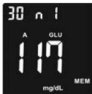
Continuare a premere il pulsante di accensione per rivedere i risultati precedenti in ordine (inclusi glucosio nel sangue e chetoni nel sangue). I risultati verranno visualizzati a partire dal più recente, ogni risultato mostrerà la data e l'ora in cui è stato eseguito il test.
