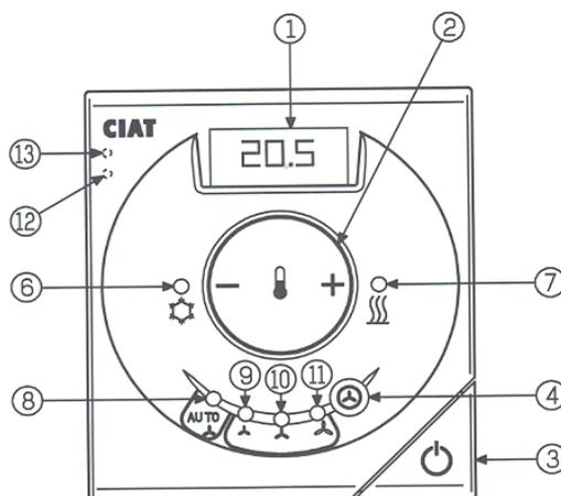
**1 – Afficheur** : En affichage permanent, il indique la température détectée par la sonde si on appuie sur la touche **2**, une réglette apparaît et on peut modifier la température désirée en appuyant sur + ou -, la température mesurée par la sonde s'affiche à nouveau 8 s après la dernière pression sur la touche **2**.
