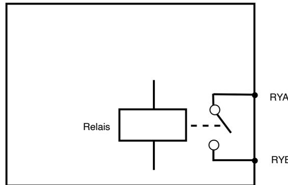
Relais externe, par exemple pour le contrôle d'un chauffe-eau.
