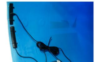
**Steg 10** Koppla in batterikabel, motorkabel och Nivågivare i respektive ingångar på terminalplinten och klicka i terminalplinten i FeedCon enheten.
