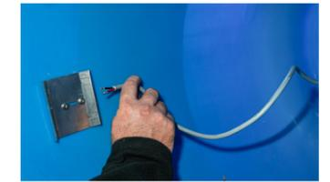
**Schritt 9** Positionieren Sie die Antennen mit Kabelbindern oder Kleber so hoch wie möglich im Container. Verbinden Sie die Antennen mit der FeedCon-Einheit.
