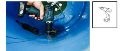
**Schritt 8** Installieren Sie FeedCon an einer geeigneten Stelle im Behälter und achten Sie darauf, dass das Kabel vom Motor bis zur FeedCon-Einheit reicht.
