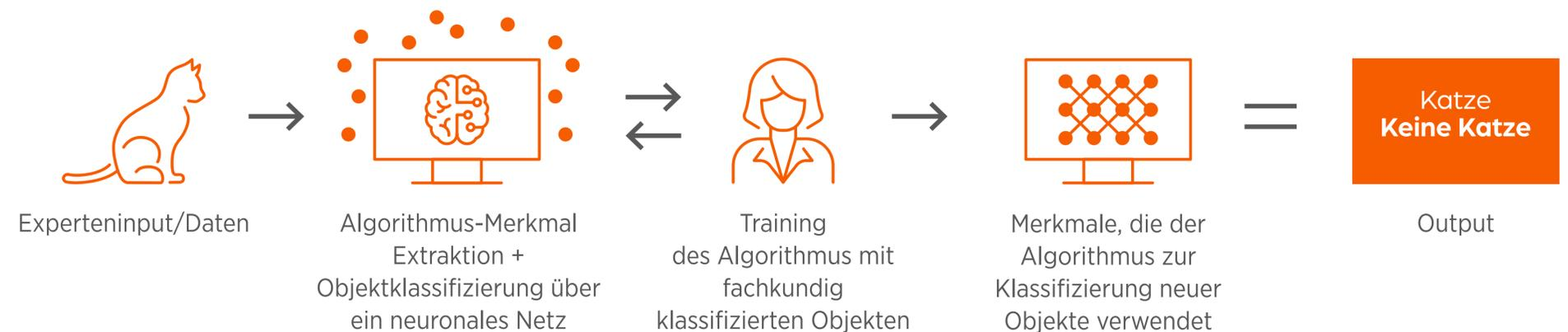
Das für Vetscan Imagyst verwendete Deep-Learning-System ist ein tiefgreifendes neuronales Netzwerk, das viele enge Filter verwendet, um eine große Anzahl von Merkmalen aus einem ausgewählten Beispielbild zu extrahieren. Diese Merkmale werden dann auf das neuronale Netzwerk für tiefes Lernen angewendet, um die Genauigkeit zu verbessern und die Probenanalyse zu automatisieren, um den Zeitaufwand des Personals zu reduzieren.
