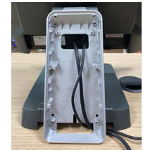
FIGURE 1 : COUVERCLE DE PROTECTION DU PASSAGE DE CÂBLES
