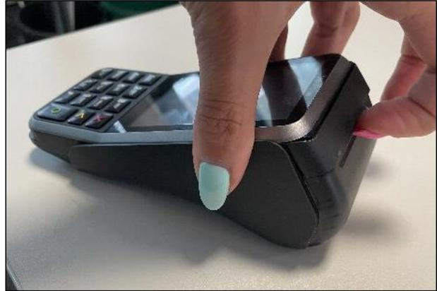
2. Insérez le rouleau en le plaçant dans le terminal et en veillant à ce que le papier dépasse légèrement.
