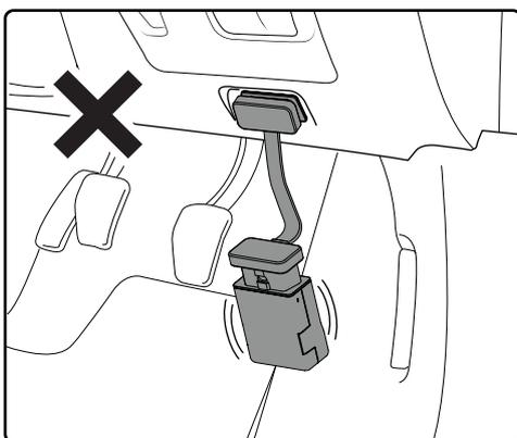
El dispositivo debe estar correctamente fijado
